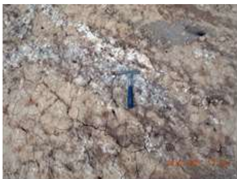
شکل (۳): آثار شوری بر سطح اراضی مارنی نئوژن غرب بیرجند به عنوان عامل مخرب کیفیت آب و خاک منطقه و نا مناسب برای بندسار
