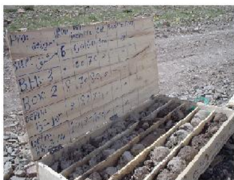
شکل (۷): حفاری چاه‌های ژئوتکنیکی در محور سد
