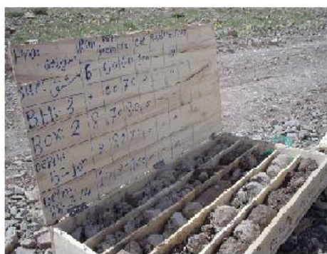
شکل (۷): حفاری چاه‌های ژئوتکنیکی در محور سد
