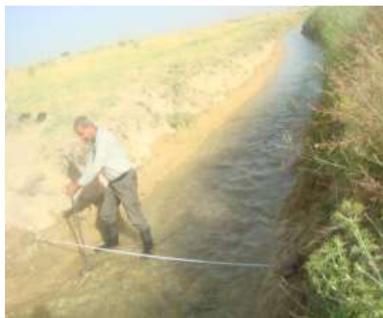
شکل (۳): اندازه‌گیری دبی در کانال خاکی آباده رامجرد
