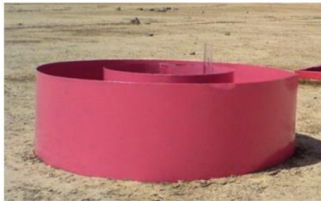
شکل (۲): حلقه‌های مضاعف آزمایش
