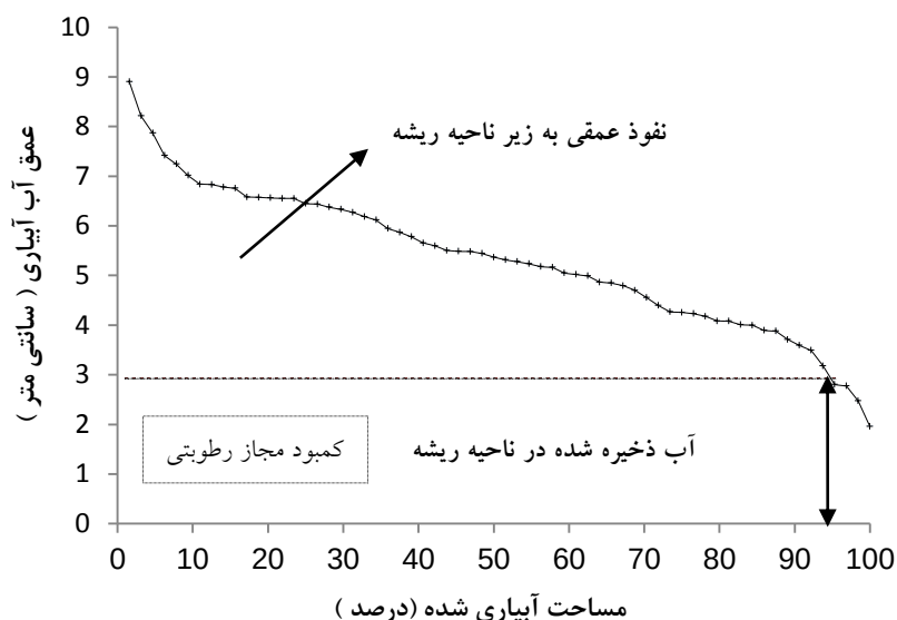
شکل (۴): منحنی کفایت آبیاری سیستم HD با ضریب یکنواختی ۷۵/۹۷٪
