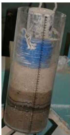
شکل (۲): استوانه حاوی نمونه خاک با تزریق ابر جاذب
