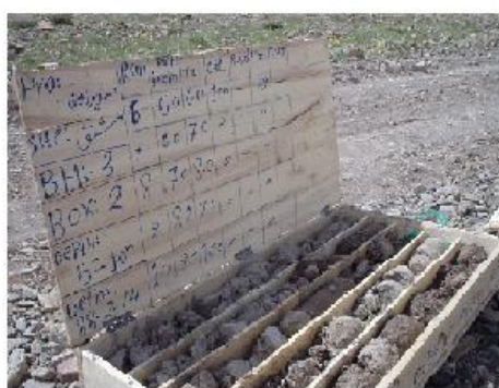
شکل (۷): حفاری چاه‌های ژئوتکنیکی در محور سد
