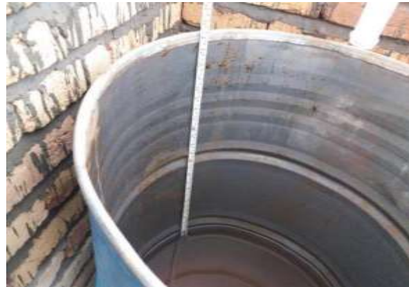
شکل (۴): اندازه‌گیری عمق رواناب و نمونه‌برداری از رواناب جهت تعیین غلظت رسوب
