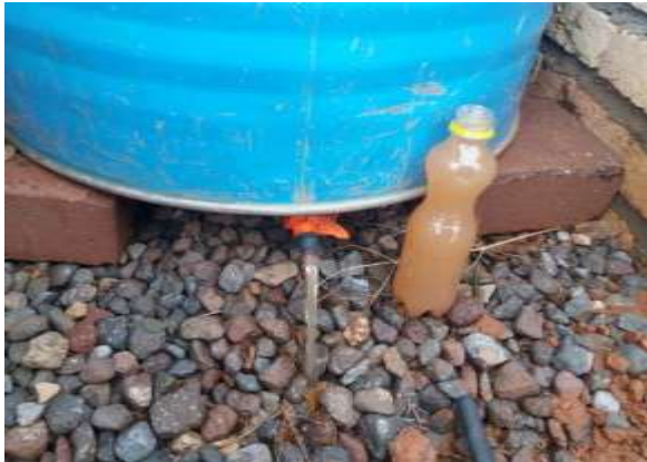
شکل (۴): اندازه‌گیری عمق رواناب و نمونه‌برداری از رواناب جهت تعیین غلظت رسوب
