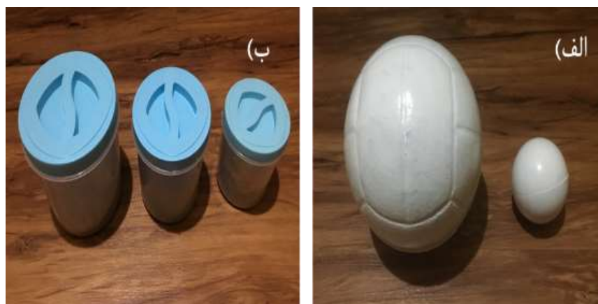
شکل (۳): (الف) شناورهای کروی. (ب) شناورهای استوانه‌ای
