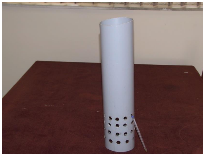
شکل ۳- نمونه‌ای از لوله پلی‌اتیلن که برای ساخت فیلتر سنگریزه‌ای به کار برده شده است Figure 3- An example of a polyethylene pipe used to make a gravelly filter
